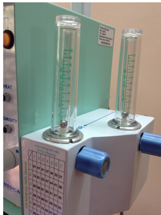
Bộ phận trộn khí trong hệ thống KSE-CPAP
