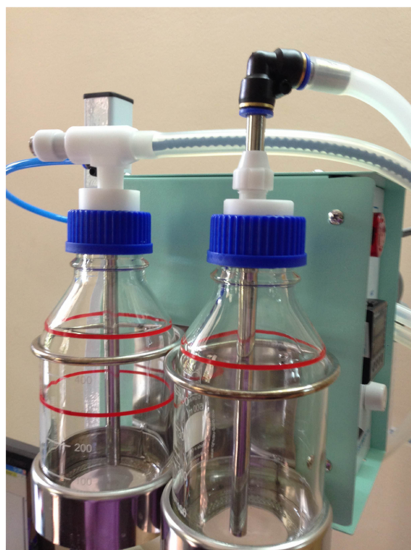
Bộ phận giữ ấm trong hệ thống KSE-CPAP
